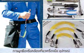
การผูกยึดเครื่องมือเกี่ยวกับตัวเครื่องมือ อุปกรณ์
