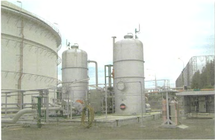
ระบบนำกลับสารอินทรีย์ระเหยง่าย (Vapor Recovery Unit : VRU)
